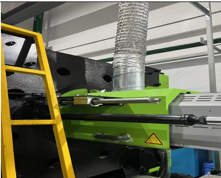
图3 注塑废气收集方式示例图
