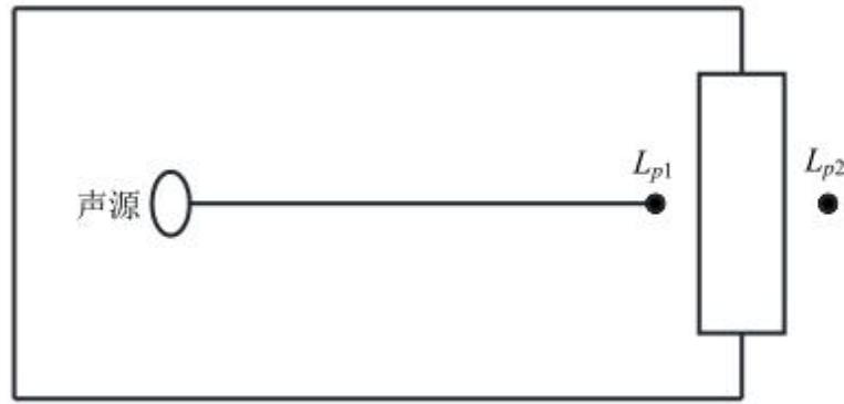
图 4-4 室内声源等效为室外声源图例
