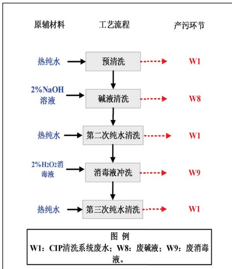
图 2-3 CIP 清洗系统工艺流程图
