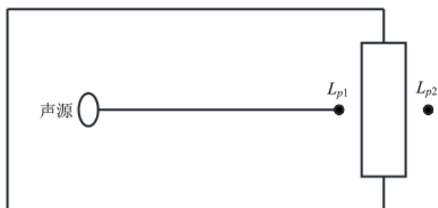
图 4-3 室内声源等效为室外声源图例
