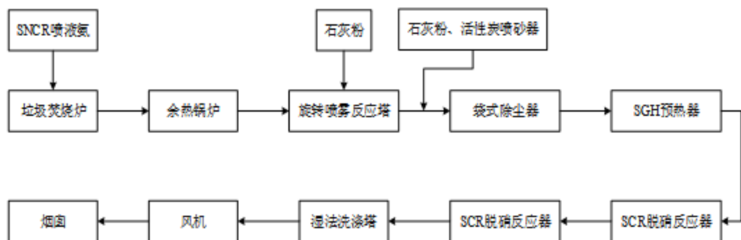
图 6.2-1 烟气治理设施工艺流程图
