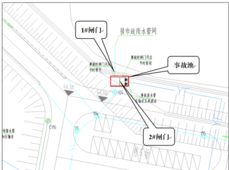
图 5.9-7 厂区前的堵漏措施图
